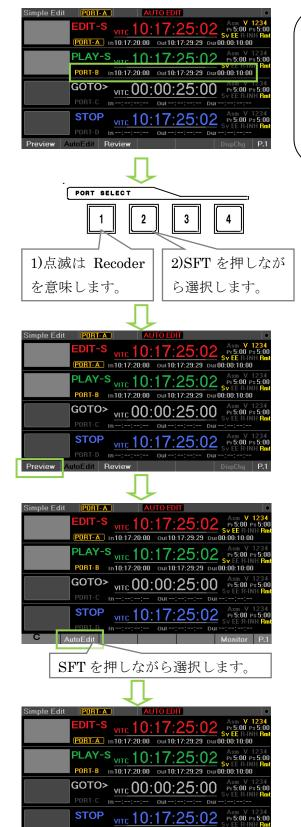
Port Select キー2で PLAYER 側の IN 点と OUT 点を決めます。 ※左右キーで IN 点 OUT 点の確認が行えます。 ※IN ボタン・OUT ボタンの長押して設定値の削除が可能です
