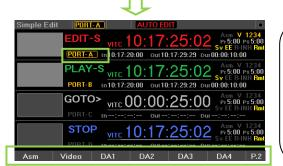
Recoderポートを選択し、SimpleEdit 画面の ファンクション表示エリア P2 で、編集モード 選択します。
