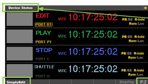
Device Status 画面のファンクション表示エリアでP2を選択してSimpleEditモードを選択します。
