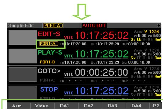
Recorderポートを選択し、SimpleEdit画面のファンクション表示エリアP2で、編集モードを選択します。
